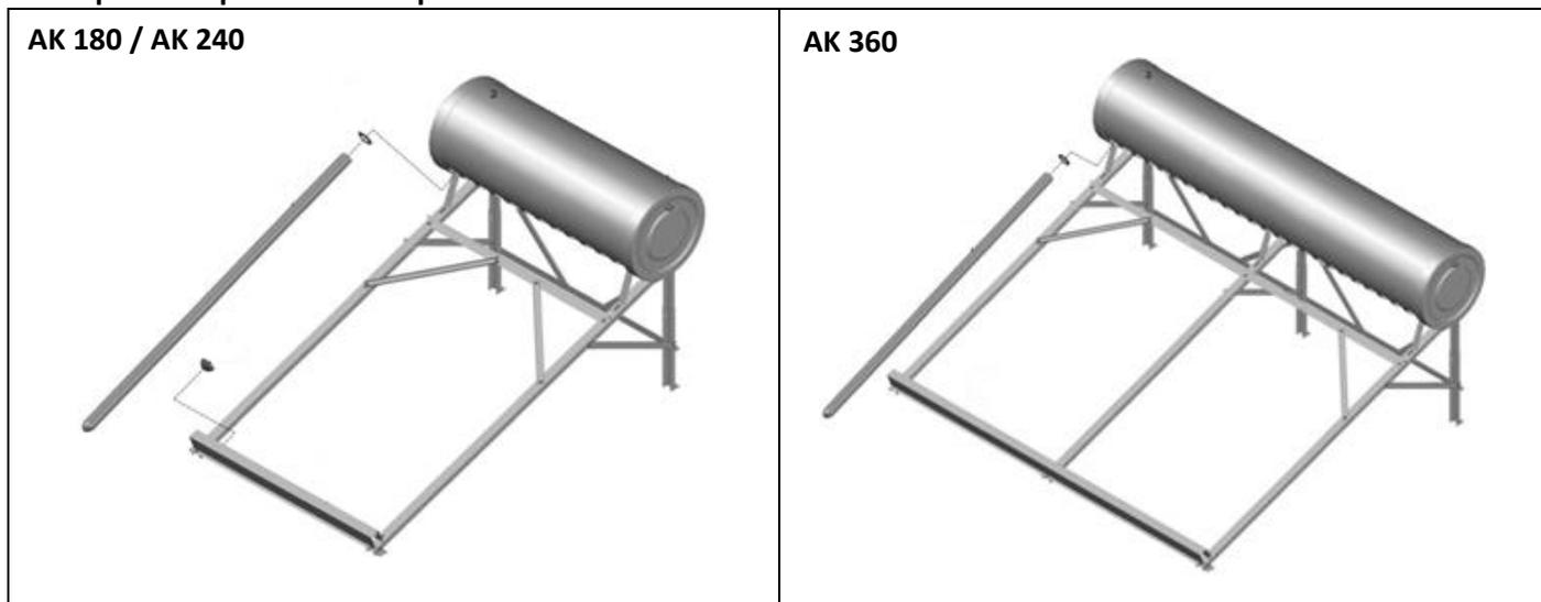
**Observação:** Ao encaixar o anel de vedação no tubo, empurre-o aproximadamente 20 cm da borda do tubo para que tenha espaço suficiente para inserir no reservatório. Encaixe a parte superior no reservatório com cuidado até que seja possível puxar o tubo para baixo, apoiando-o ao suporte de apoio do tubo. Repita este procedimento para todos os tubos.
