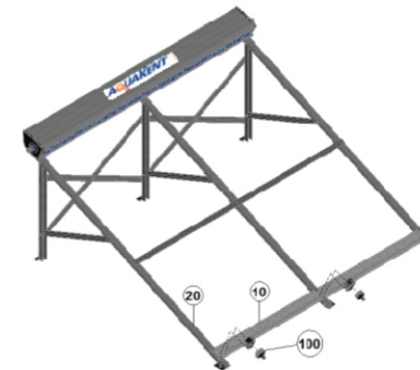
Figura 8-Montagem de suporte metálico
