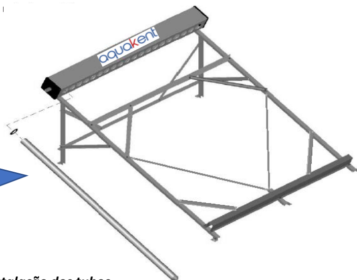
Figura 10 – Instalação dos tubos
